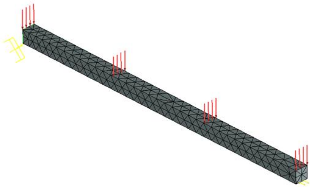
Рисунок 1.17-2 - Конечно-элементная модель с указанными нагрузкой и закреплениями
