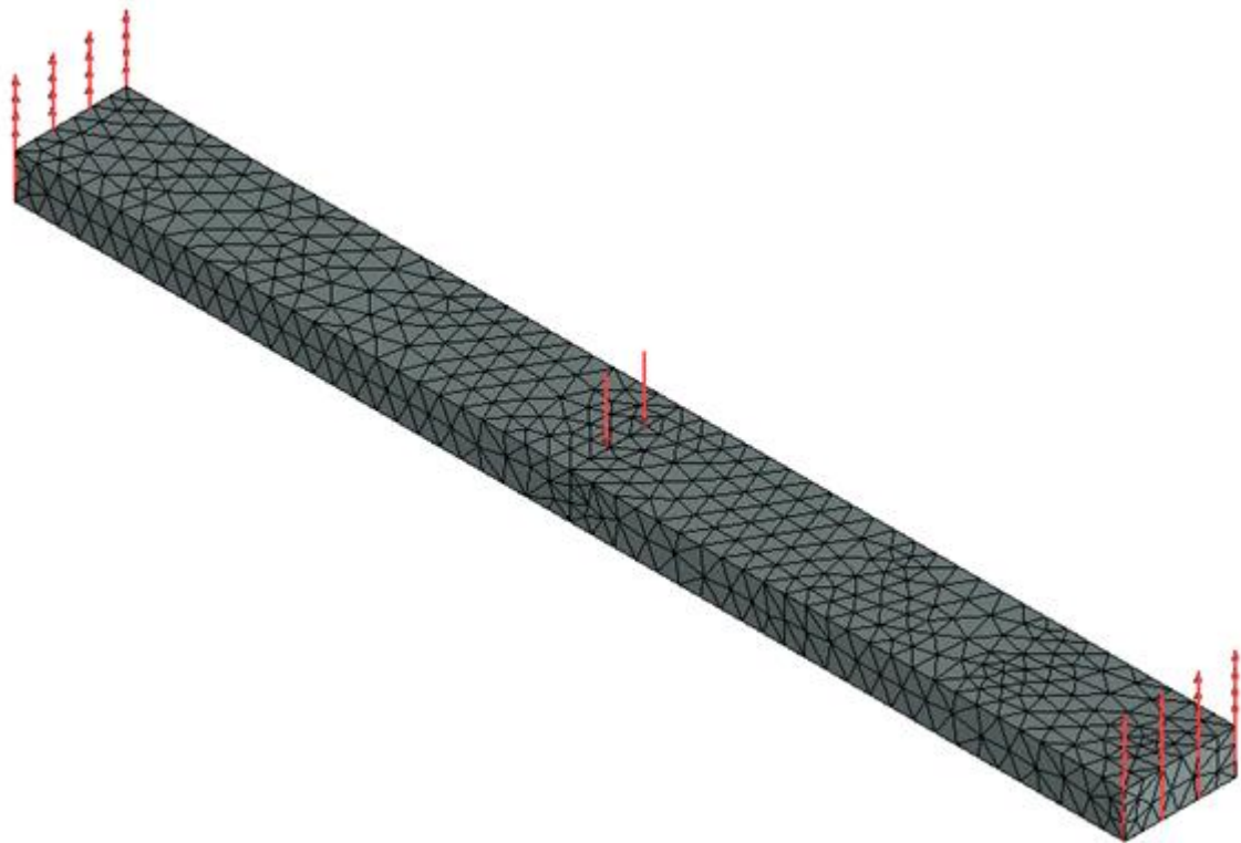
Рисунок 1.13-1 Расчетная модель с нагрузками и закреплениями
