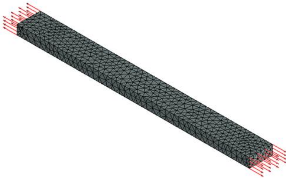
Рисунок 1.19-1 - Конечно-элементная модель при указанных нагрузке и закреплении.
