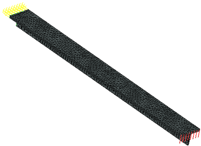
Рисунок 1.14-1 - Расчетная модель с нагрузками и закреплениями
